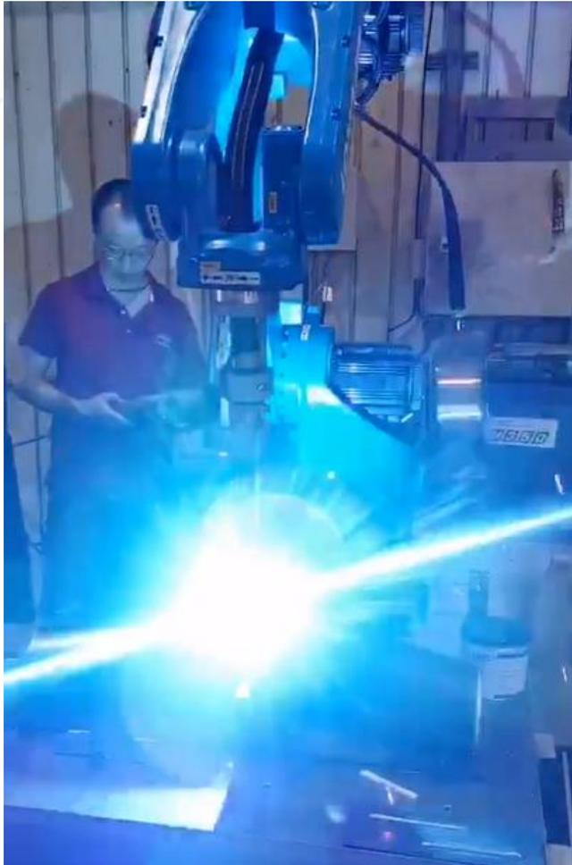
焊接作業時，會產生電焊弧光，當光輻射作用在人體上，眼部受到強烈的紅外線輻射，會立即感到強烈的灼傷和灼痛，發生閃光幻覺。長期接觸可能造成紅外線白內障、視力減退，嚴重時可導致失明。
