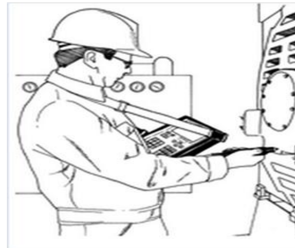
使用于設備振動偏移監測的手動探棒方法缺乏重複性與可靠性。
