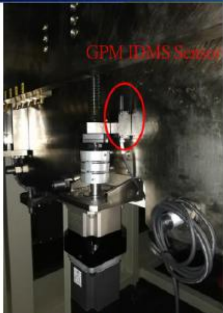
Sensor安裝於導螺桿的軸承座上(Tilt 單元)
